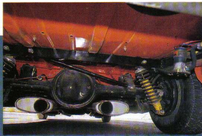
Alusta tehtiin ajettavaksi. Fordin ysituumainen taka-akseli tuettiin coil over -iskareilla ja Impalan neliinlinkillä.
